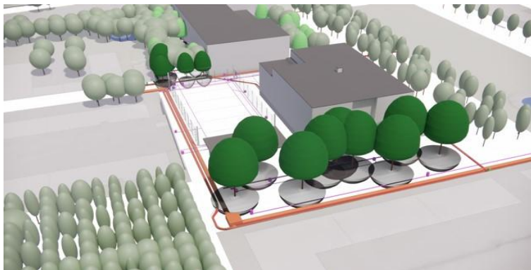
Figure 15: Exemple de coordination fondée sur la planification BIM pour les éléments d'espaces libres. / Source : Landscale AG, 2024
